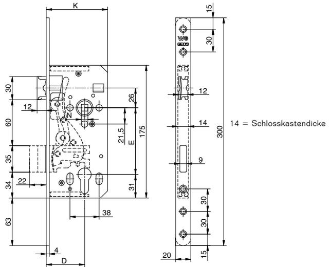
Ausfräsung für Schlosskasten = Schlosskastendicke + 2 mm
